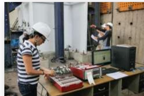
地震の揺れによる壁面ダメージ計測をするセンター員（写真：岡原 功祐/JICA）
